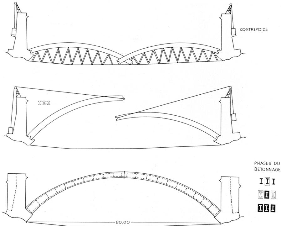
Dibujo del proceso de construcción del puente
